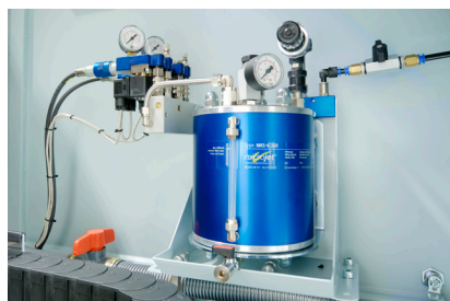
Minimalmengenschmiersystem mit einstellbaren Hübren pro Minute Minimum Quantity Lubrication system with adjustable strokes per minute
